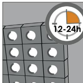
**16.** Es empfiehlt sich nach der Montage von etwa 4-5 Reihen 12-24 Stunden zu warten, bis der Kleber angetrocknet ist. So vermeiden Sie eine Verformung der Konstruktion auf Grund des Eigengewichtes der Keramiksteine.
