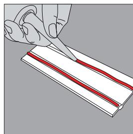
**7.** Tragen Sie den Kleber wie in Schritt 4 nun auf das kurze Profil auf.
