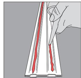
**4.** Geben Sie auch auf die Erhöhungen des bereits geklebten Bodenprofils Kleber.
