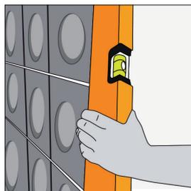
**14.** Verfahren Sie mit den weiteren Keramiksteinen genauso, wie bei der Montage der ersten Reihe. Kontrollieren Sie fortlaufend mit einer Wasserwaage, ob die Keramiksteine korrekt ausgerichtet sind.
