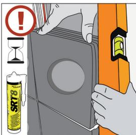
**15.** Durch das Eigengewicht der Steine können sich zuerst gelegte Reihen eventuell verschieben. Kontrollieren und korrigieren Sie daher häufiger, bevor der Kleber angetrocknet ist.
