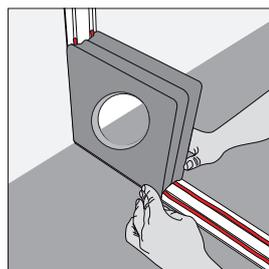
**6.** Setzen Sie den ersten Keramikstein auf das Profil. Beginnen Sie an der Wandseite. Richtig positioniert sollte der Keramikstein ein wenig absinken. Prüfen Sie durch vorsichtiges Anheben, ob der Kleber richtig haftet.
