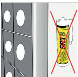
**19.** Optional können Sie Ihre Wand mit einem Abschlussprofil versehen: Geben Sie nun Silikon in die äußeren Bereiche im Inneren der Abschlussprofile. Verwenden Sie hierfür auf gar keinen Fall den SRT8 Kleber! Das Abschlussprofil lässt sich dann nie wieder entfernen.
