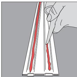
**1.** Montage des Bodenprofils: Geben Sie zunächst jeweils einen 5-6mm dicken Streifen Kleber auf die zwei Erhöhungen des Profils. Beide Seiten des Profils sind gleich.
