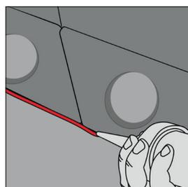
**18.** Versiegeln Sie abschließend mit Silikon die Anschlussfugen zwischen den Keramiksteinen und Boden/Wand.
