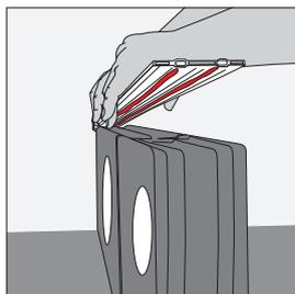
**13.** Legen Sie das Profil mit dem Kleber nach unten auf die Keramiksteine. Drücken Sie das Profil ein wenig an.
