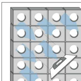
**17.** Warten Sie mindestens 24 Stunden bis Sie mit dem Verfugen beginnen. Verwenden Sie dazu einen handelsüblichen Flex-Fugenmörtel und folgen Sie den Anweisungen des Herstellers. Drücken Sie mit einem Gummispachtel den Fugenmörtel in die Fugen. Waschen Sie dann mit einem Schwamm die Fugen aus.
