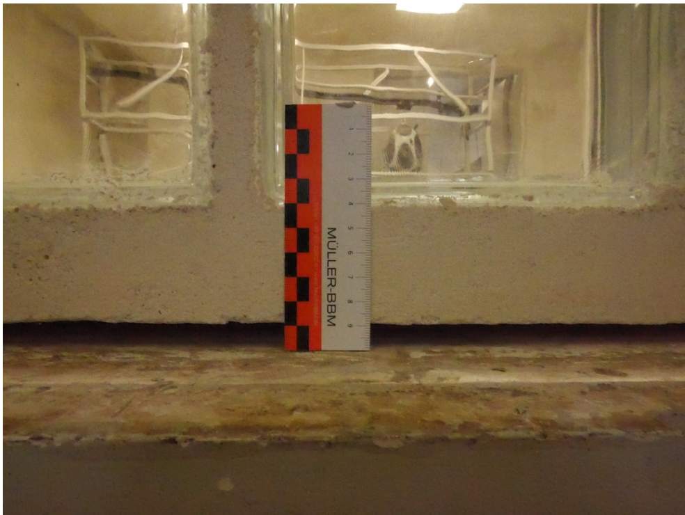
Abbildung B.3. Mörtelumschließung des Prüfelementes unten, Anschlussfuge zum Prüfstand noch ohne Abdichtung.
