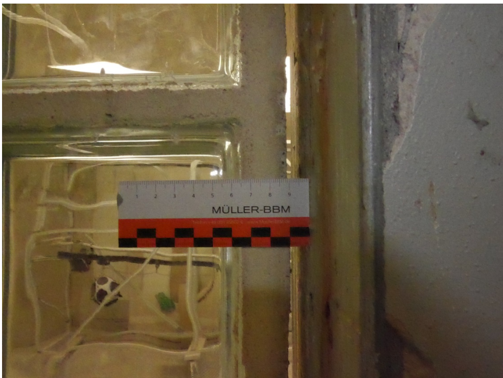
Abbildung B.4. Mörtelumschließung des Prüfelementes unten, Anschlussfuge zum Prüfstand noch ohne Abdichtung.
