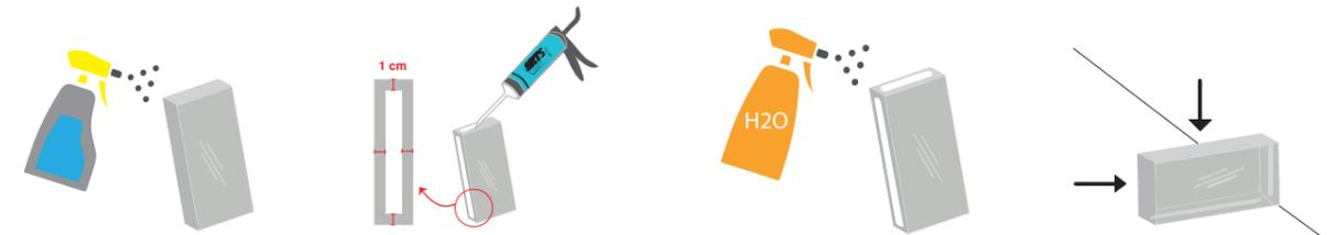
**1** Reinigen Sie vor der Verklebung alle Klebeflächen der Glasziegel mit dem SRT5 Montagespray.
