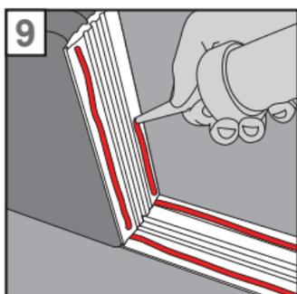
9. Geben Sie wiederum Kleber auf das soeben an den Glasstein geklebte kurze Profil und bestäuben es mit Wasser.
