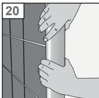
20. Raccourcissez les profils d'extrémité aux dimensions du mur fini à l'aide d'une scie à métaux. Fixez le profil avec du silicone et non avec le SRT, pour pouvoir enlever le profil en cas de révision. Votre cloison en briques de verre est maintenant terminée.
