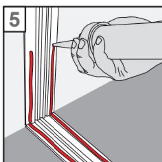
5. Maintenant appliquez du SRT sur le profil mural, jusqu'à la hauteur d'une brique de verre, et saupoudrez l'adhésif avec de l'eau.
