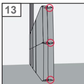
13. Achten Sie bei jeder Reihe darauf, dass alle Profile gleich ausgerichtet sind, d.h. die Einschubkanäle (NUT) für die LED-Streifen müssen in die gleiche Richtung zeigen.
