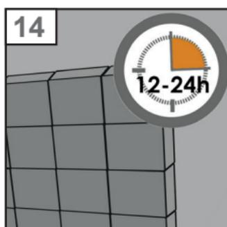
14. Es empfiehlt sich nach der Montage von etwa 4-5 Reihen 12-24 Stunden zu warten, bis der Kleber angetrocknet ist. So vermeiden Sie eine Verformung der Konstruktion auf Grund des Eigengewichtes der Glassteine. Warten Sie in jedem Fall mindestens 24 Stunden, bevor Sie die fertige Wand verfugen.
