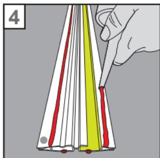
4. Geben Sie nun Kleber auf die glatte Fläche des Bodenprofils und bestäuben dies mit Wasser. **ACHTUNG:** arbeiten Sie sauber, denn es darf kein SRT in die NUT gelangen, damit der LED-Streifen später auch in die NUT eingeschoben werden kann.
