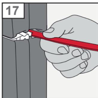
17. Faites glisser les bandes de LED dans les RAINURES des profils.
