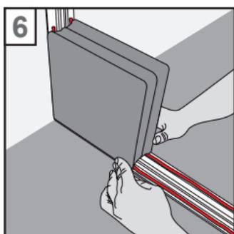
6. Placez la première brique de verre sur les profils. Correctement positionné, la brique devrait s'enfoncer un peu. Soulevez-la avec précaution pour vérifier si l'adhésif adhère bien.
