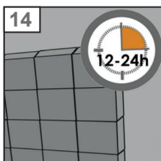
14. Nous recommandons d'attendre 12 à 24 heures après le montage de 4 à 5 rangées, jusqu'à ce que la colle ait séché, pour éviter une déformation de la construction due au poids des briques de verre. De toute façon, attendez au moins 24 heures avant de jointoyer le mur fini.
