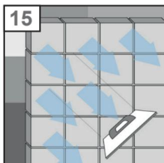
15. Verwenden Sie zum Verfugen unsere Glasstein FlexFuge. Tragen Sie mit einem Gummispachtel oder Fugenbrett die Fugenmasse diagonal auf dem Glasstein auf. Füllen Sie die Fugen vollständig auf und ziehen diese anschließend mit einem feuchten Schwamm glatt. Dabei entfernen Sie auch die restliche Fugenmasse von den Glassteinen.
