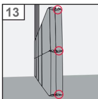
13. Assurez-vous que tous les profils sont alignés de la même manière pour chaque rangée; les canaux d'insertion des bandes de LED (RAINURE) doivent être orientés dans la même direction.
