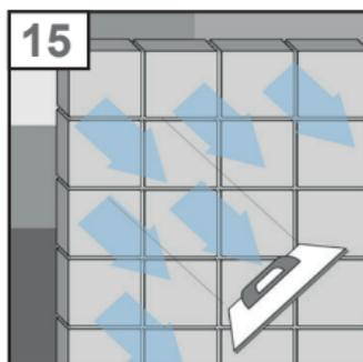
15. Utilisez notre produit FlexFuge pour de briques de verre pour le jointoiment. Appliquez le mastic de jointoiment en diagonale sur la brique de verre à l'aide d'une spatule en caoutchouc ou d'une planche à joint. Remplissez complètement les joints et lissez-les ensuite avec une éponge humide. Enlevez les restes de mastic des briques de verre.
