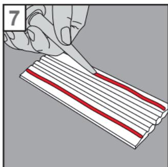
7. Tragen Sie Kleber auf eine Seite des kurzen Profils auf und bestäuben den Kleber mit Wasser.
