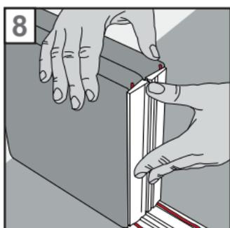
8. Collez le profil verticalement à la brique de verre, en veillant à ce qu'il bute contre le profil long déjà collé ou qu'il ne dépasse pas de la brique de verre et ne gêne pas l'alignement exact du profil long suivant par la suite.
