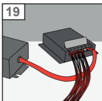
19. Befestigen Sie Netzteil und Controller z.B. in der Wand, einer doppelten Decke, einem Revisionsschacht usw. Beachten Sie die vorgeschriebenen Mindestabstände zu wasserführenden Bauteilen. Verbinden Sie die Kabel der LED-Streifen mit dem Controller und diesen mit dem Netzteil (siehe Schaltplan S.5). Der elektrische Anschluss ist von einem Fachmann vorzunehmen.
