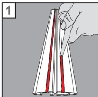
1. Assemblage du profil de sol: Prenez un profil avec une RAINURE (avec marquage) avec la RAINURE vers le bas. Tout d'abord, appliquez une bande de colle de montage de 5-6 mm de large sur les évidements du profilé et saupoudrez-le d'eau.
