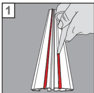
1. Montage des Bodenprofils: Nehmen Sie ein Profil mit NUT (mit Markierung), dabei zeigt die NUT nach unten. Geben Sie zunächst jeweils einen 5-6 mm breiten Streifen Montagekleber in die Vertiefungen des Profils und bestäuben diesen mit Wasser.
