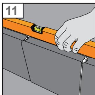
11. Wenn die erste Reihe fertig ist, prüfen Sie mit einer Wasserwaage, ob die Glassteine gerade sind. Solange der SRT Montagekleber noch nicht getrocknet ist, können Sie leichte Korrekturen vornehmen.
