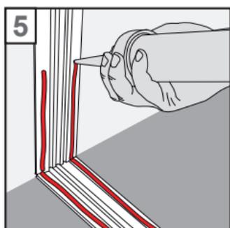
5. Tragen Sie nun den SRT auf das Wandprofil auf, bis zur Höhe eines Glassteines, und bestäuben den Kleber mit Wasser.
