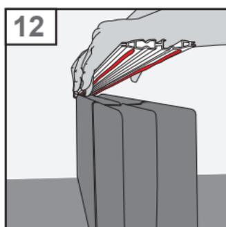
12. Nehmen Sie wieder ein Profil mit einer NUT (mit Markierung), dabei zeigt die NUT nach oben. Jetzt tragen Sie den Kleber mittig auf die glatten Flächen auf. Legen Sie das Profil mit dem Kleber nach unten auf die zuvor montierte Glassteinreihe. Drücken Sie dabei die Leiste ein wenig an, um sicher zu gehen, dass der Kleber richtig an den Glassteinen haftet.
