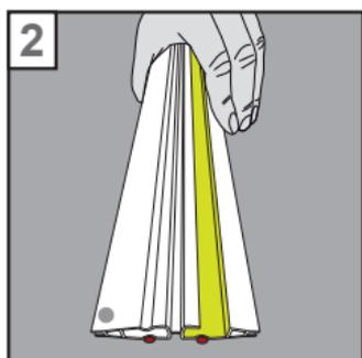
2. Entscheiden Sie sich, in welche Richtung die LED-Streifen leuchten sollen, und richten danach die NUT aus. Alle weiteren Reihen werden gleich ausgerichtet, siehe Punkt 13 auf Seite 10. Drehen Sie das Profil nun um und drücken die Seite mit dem Kleber fest auf den Boden an, die NUT zeigt nun nach oben.
