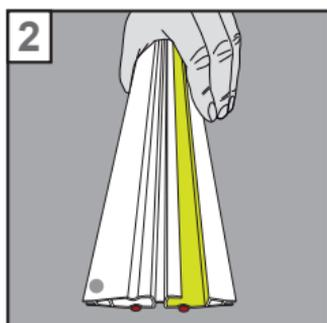
2. Décidez dans quelle direction les bandes de LED doivent briller, puis alignez la RAINURE. Toutes les autres rangées sont alignées de la même manière, voir le point 13 de la page 22. Retournez maintenant le profil et l'appuyez fermement sur le sol avec le côté adhésif, la RAINURE est dirigée vers le haut.
