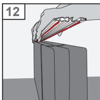
12. Prenez un autre profil avec une RAINURE (avec marquage), la RAINURE pointant vers le haut. Appliquez l'adhésif au centre des surfaces lisses. Placez le profil sur la rangée de briques de verre préalablement montée, l'adhésif vers le bas. Appuyez légèrement sur le profil pour que l'adhésif adhère correctement aux briques de verre.
