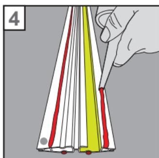
4. Appliquez de la colle sur la surface lisse du profil de sol et saupoudrez-la d'eau. ATTENTION: travaillez proprement, car aucun SRT ne doit entrer dans la RAINURE, afin que la bande LED puisse être insérée dans la RAINURE plus tard.
