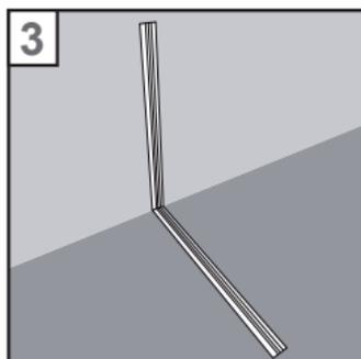
3. Montage des Wandprofils: Nehmen Sie ein Profil ohne NUT (ohne Markierung) und kleben Sie es wie das Bodenprofil fest. Stellen Sie anschließend sicher, dass der Winkel zwischen beiden Profilen 90° beträgt.
